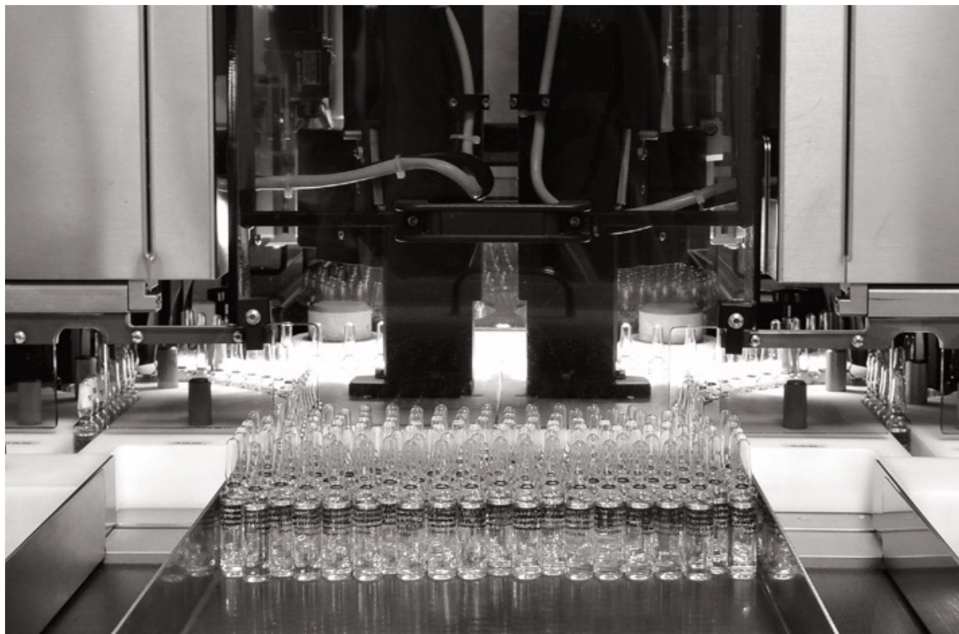
Revisadora de ampollas para la inspección visual de partículas y volumen en inyectables. Planta de inyectables de Reig Jofre.
